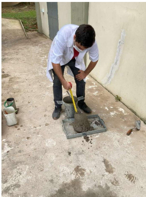
Figura 22 – Ensaio no estado fresco (slump test)
