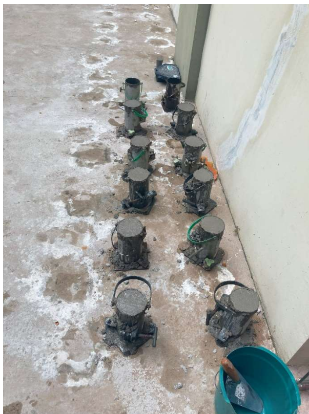
Figura 23 – Moldagem dos Corpos de Prova Fonte: Própria (2022)
