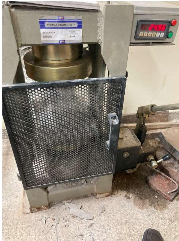
Figura 25 – Ensaio Compressão Axial, Prensa Manual Fonte: Própria (2022)
