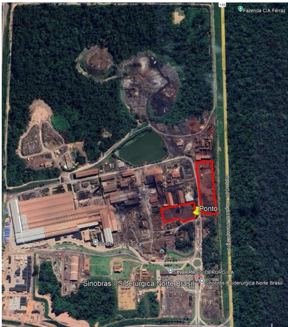
Figura 11 – Mapa de Localização, Local da coleta, coordenada Latitude 5°24'51.41"S Longitude 49° 4'39.86"O, área aproximada dos pátios para depósitos de escória 24.500 m²
