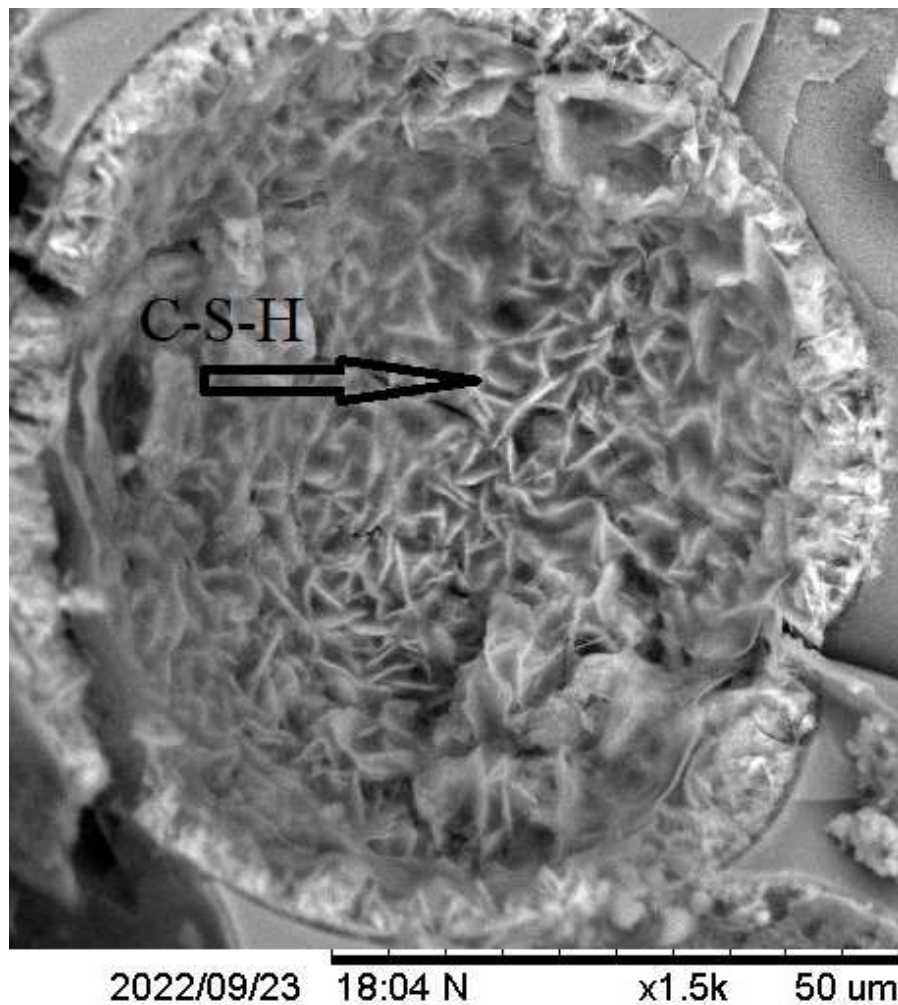
Figura 32 - Presença das fissuras somente na região do agregado de EAF, assim como grande quantidade de C-S-H
