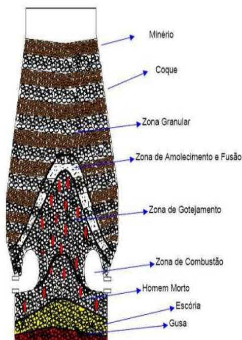
Figura 7 – Esquema da parte interna do alto forno (zonas de amolecimento e fusão e de gotejamento)
