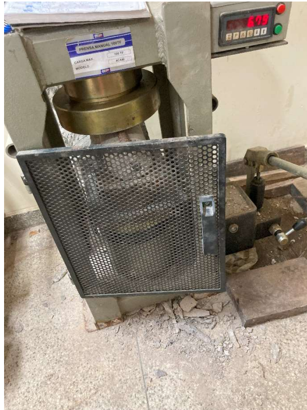
Figura 26 – Ensaio de Tração por compressão diametral Fonte: Própria (2022)
