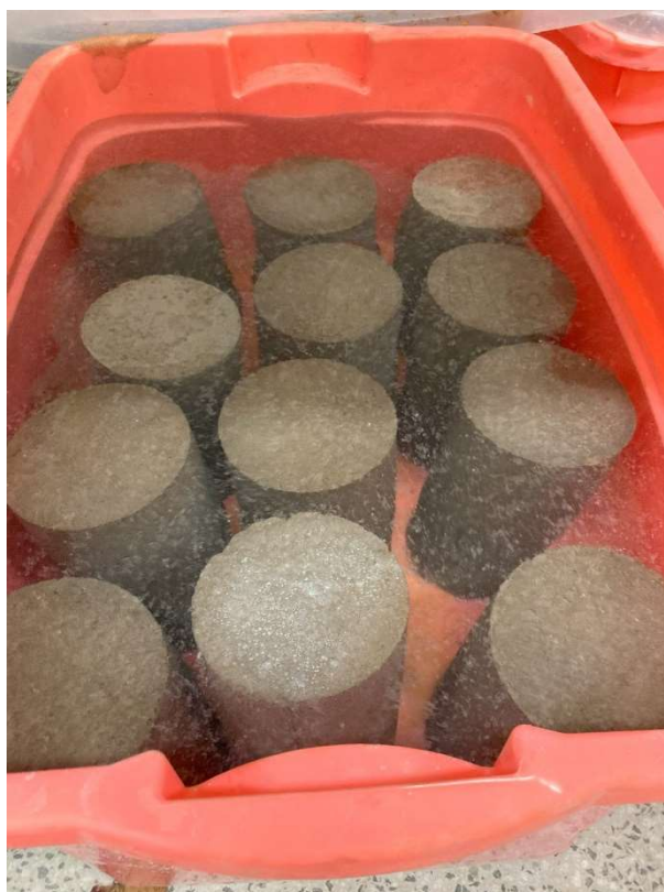
Figura 24 – Cura Úmida Fonte: Própria (2022)
