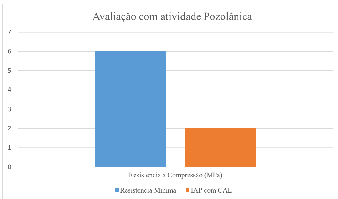
Figura 17 - Avaliação da atividade pozolânica com cal da escória de alto-forno.
